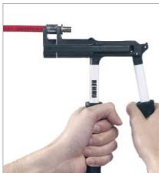
9. Плавно без рывков сведите рукоятки инструмента, и надвиньте гильзу до фланца фитинга. Соединение готово!
