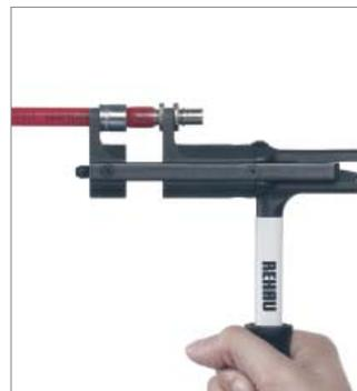
8. Полностью захватите соединение запрессовочным инструментом.
