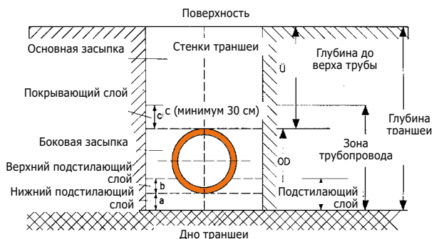
Рис. 3 Устройство траншеи
