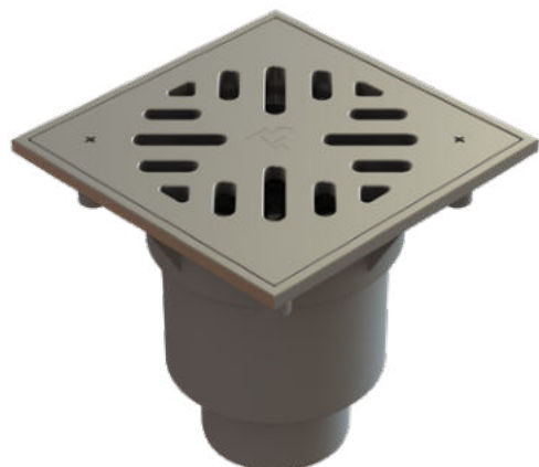
ТП-606S Трап дворовый с мусоросборником, с запахозапирающим устройством с вертикальным выпуском 160/110 мм
