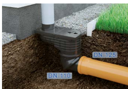
5. Присоедините отводящую трубу DN110 - напрямую DN125 - отпилите участок Ø110 мм!
