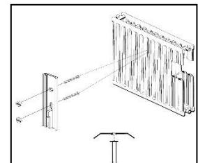
Стальные панельные радиаторы PRADO имеют заводское исполнение под фирменный крепеж (КМЧ №8).
