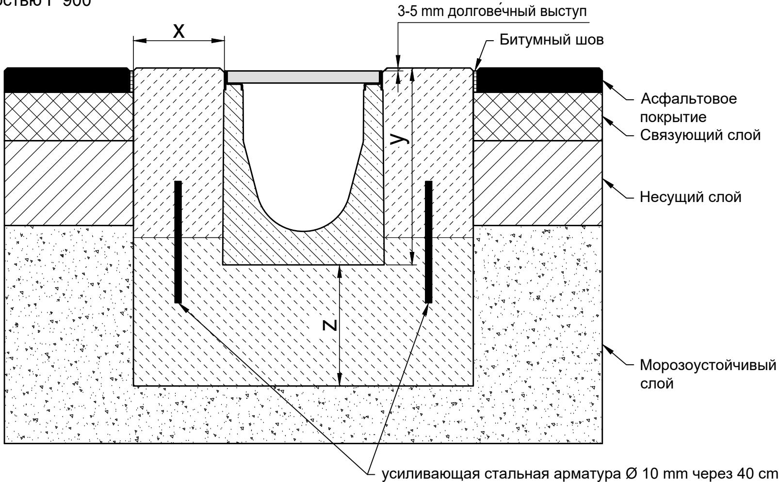
Классы нагрузки в соответствии с EN 1433 / DIN 19580
