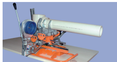
готовое сварное соединение после охлаждения
