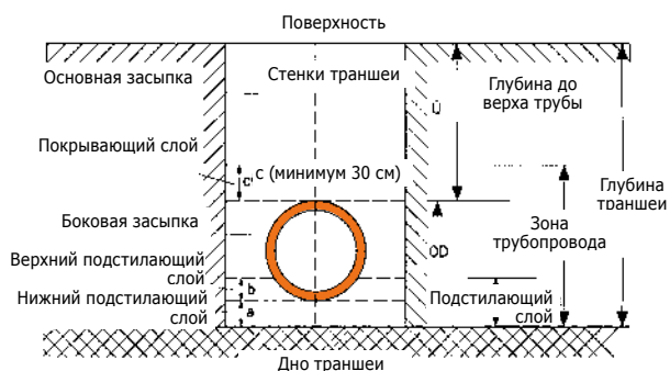
Рис. 3 Устройство траншеи
