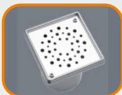
4Б-Трап пластик. D 110 мм. 150x150 с мет.нерж. решет.,и сухим затвором (вертикальный) Артикул: 5-0047 Количество в упаковке: 20
