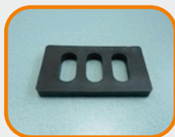
Прокладка /терморазрыв/ под кронштейн несущий с 3 эллипс.отверстиями (полиамид) ПКН 55-100
