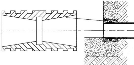
Гильзы прохода через стену применяются для входных и выходных труб, они устанавливаются внутри заподлицо со стенкой колодца и по завершении монтажа заливаются бетоном. Гильзы позволяют вставленной трубе отклоняться на 3°.
