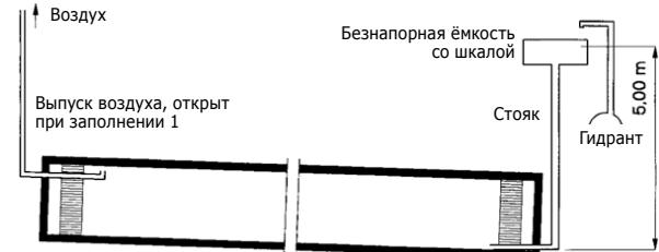
Между заполнением и испытанием трубопровода должно пройти достаточное время (1 час), чтобы оставшийся в трубопроводе после заполнения воздух мог постепенно выйти наружу.
