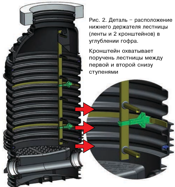
Рис.1. Лестница из стеклопластика в колодце Tegra 1000 NG
