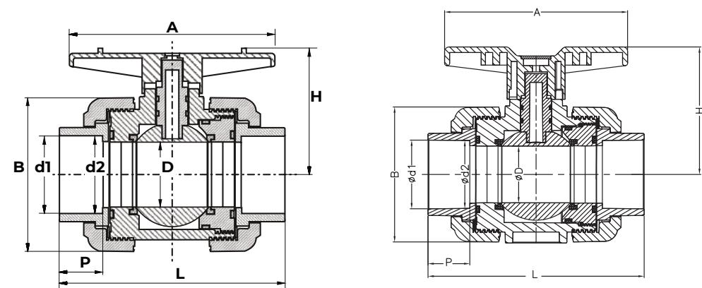
**СХЕМА КРАНА ШАРОВОГО ДО Ø63**
